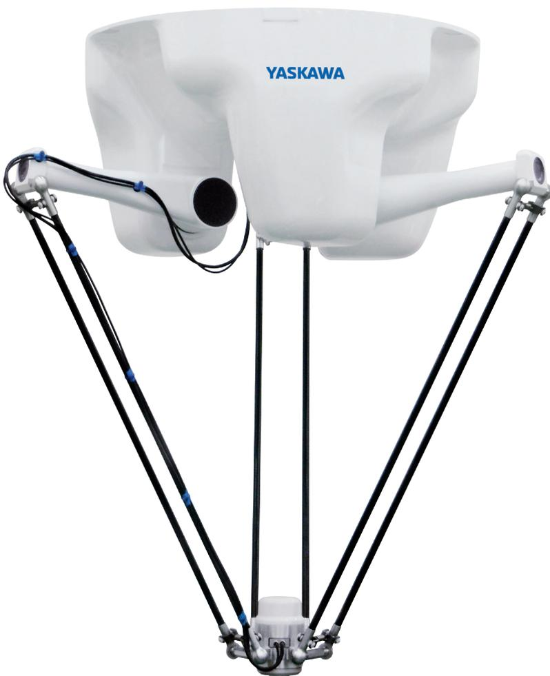
Der kompakte 4-achsige Hochgeschwindigkeitsroboter MOTOMAN MPP3H mit Parallelkinematik verbindet die Schnelligkeit der Delta-Bauform mit einer hohen Traglast und einem großen Arbeitsbereich. Aufgrund des hohen Drehmoments der vierten Achse, der sogenannten Handachse, bewegt der MOTOMAN MPP3H Traglasten bis zu 3 kg mit einer bisher unerreichten Schnelligkeit. Er kann in einer Vielzahl von Bereichen eingesetzt werden, wie z.B. in der Lebensmittel-, Pharma- und Automobilindustrie.
