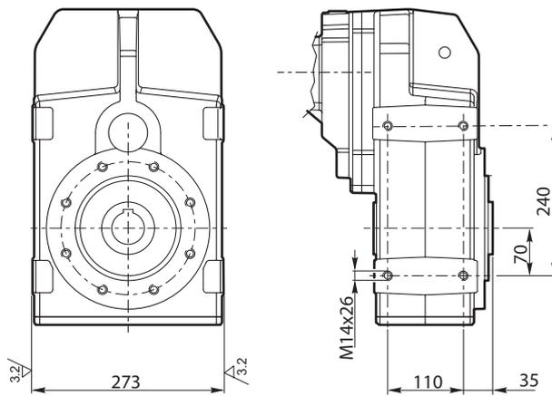
Flange uscita / Output flange / Abtriebsflansch
