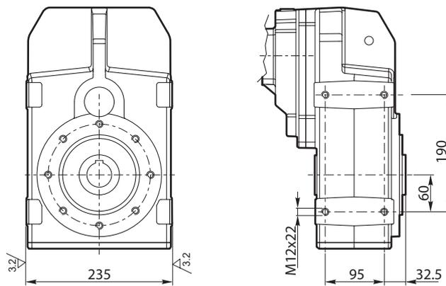
Flange uscita / Output flange / Abtriebsflansch
