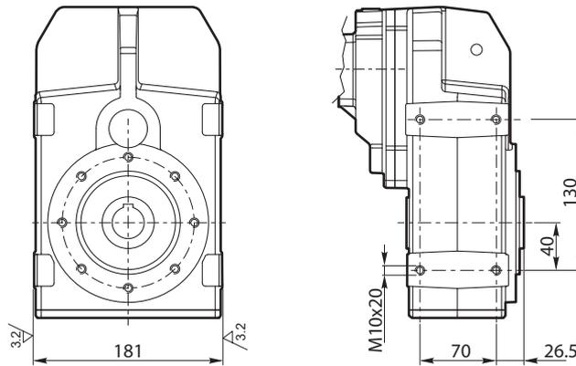
Flange uscita / Output flange / Abtriebsflansch
