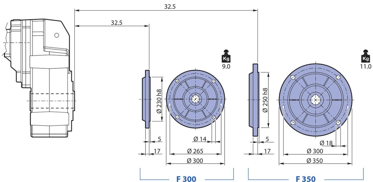
Dati tecnici riduttori/ Reducer technical data / Technische Daten Getriebe
