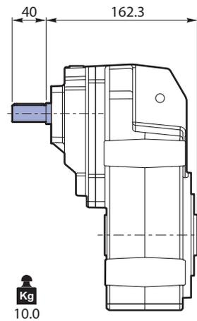
Albero uscita / Output shaft / Abtriebswelle
