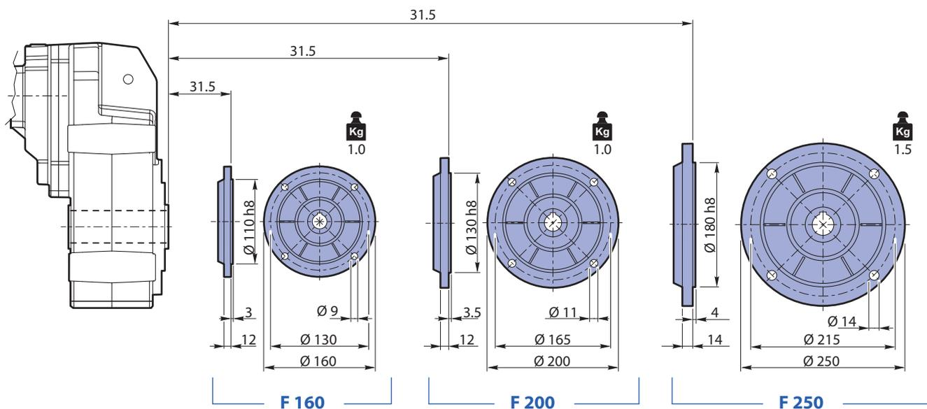
Dati tecnici riduttori/ Reducer technical data / Technische Daten Getriebe
