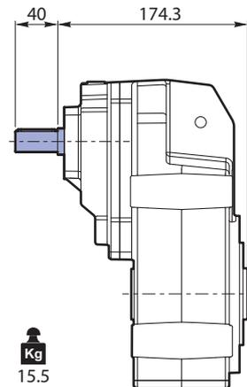
Albero uscita / Output shaft / Abtriebswelle
