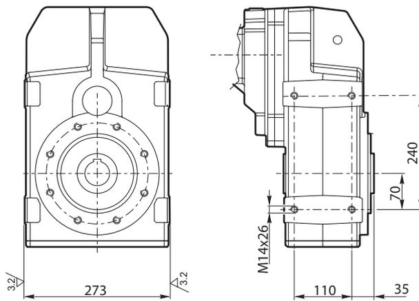
Flange uscita / Output flange / Abtriebsflansch
