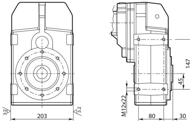
Flange uscita / Output flange / Abtriebsflansch
