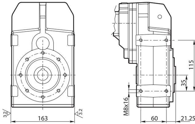
Flange uscita / Output flange / Abtriebsflansch
