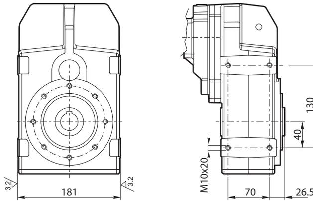
Flange uscita / Output flange / Abtriebsflansch
