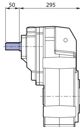
**Albero uscita / Output shaft / Abtriebswelle**
