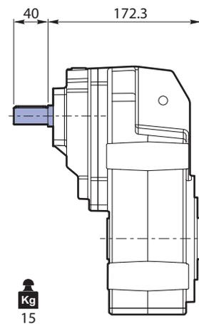
**Albero uscita / Output shaft / Abtriebswelle**
