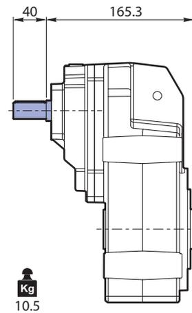
Albero uscita / Output shaft / Abtriebswelle
