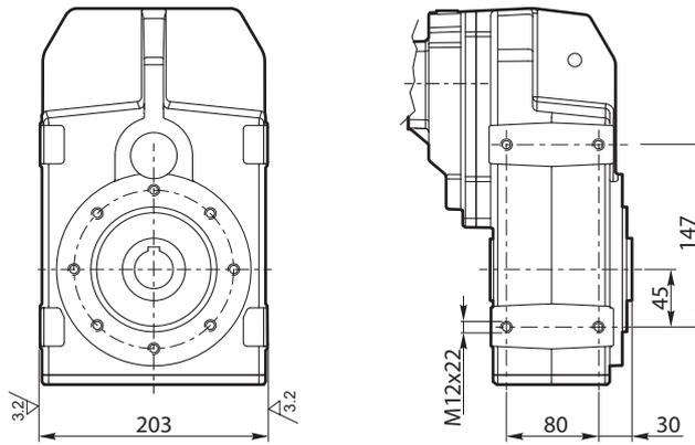
Flange uscita / Output flange / Abtriebsflansch
