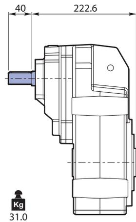
Albero uscita / Output shaft / Abtriebswelle
